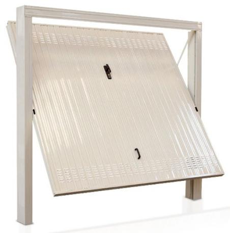
72. Fornitura e posa tra il garage e il locale disimpegno/vani scala di porta tagliafuoco EI 120 realizzata con doppia lamiera zincata e verniciata in tinta RAL 9018 (bianco papiro), con interposto materiale coibente ad alta densità, completa di cerniere, serratura a cilindro tipo Yale e maniglia antinfortunistica colore nero.
