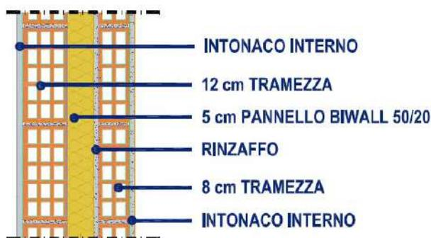
3. Realizzazione di **tramezze di divisione interne**, mediante la posa di blocchi in **laterizio forato, dello spessore di 8 cm.**, lavorati con malta bastarda, compreso gli occorrenti ponteggi interni e gli architravi delle porte interne.
