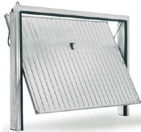
56. Fornitura e posa tra il garage e il locale disimpegno di **porta tagliafuoco EI 60** realizzata con doppia lamiera zincata e verniciata in tinta RAL 9018 (bianco papiro), con interposto materiale coibente ad alta densità, completa di cerniere, serratura a cilindro tipo Yale e maniglia antinfortunistica colore nero.
