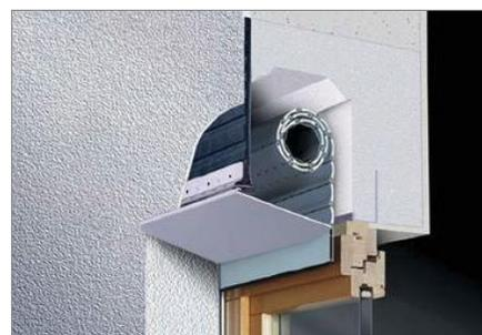
Il sistema di oscuramento sarà di tipo a tapparella con cassonetto di tipo inverso e ispezione esterna per una ottimizzazione dell'isolazione acustica e termica. Avvolgibile elettrico con manto in stecche di alluminio rullato doppia parete con anima in poliuretano espanso.
