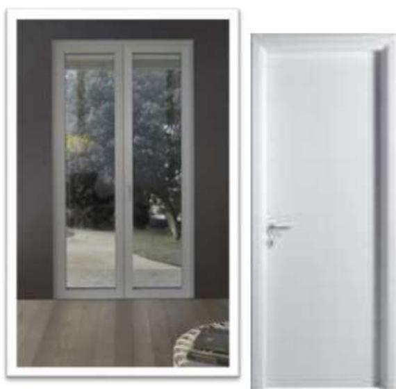
Tutti gli infissi esterni saranno in PVC (trasmissione <math><1,5 \text{ W/m}^2\text{K}</math>) a discrezione della proprietà; vetro camera termoacustica isolante basso emissiva 4+15+6 oppure 5+15+5 riempita con Argon oppure Krypton e tapparelle avvolgibile in alluminio coibentato. Le porte interne agli alloggi, di dimensioni cm 70-80 x 210, sono previste tamburate, cieche, lisce, laccate bianche, dello spessore di mm. 45,
