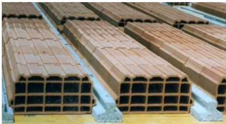
I solai dei vari piani saranno realizzati in opera con travetti in c.a. prefabbricati, e pignatta di alleggerimento. Solaio a travetti precompressi in calcestruzzo armato precompresso vibrofinito, con trefoli aderenti pre-tesi, provvisti di Attestato di
