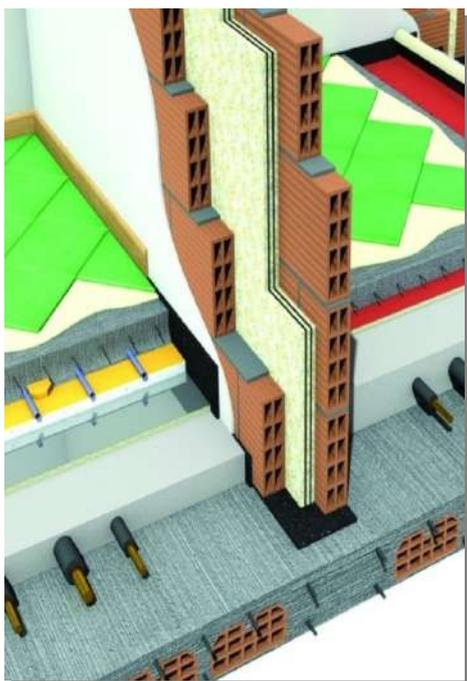
Al fine di garantire un buon isolamento acustico dei singoli alloggi verranno adottati particolari accorgimenti nei pavimenti, nelle pareti divisorie fra gli alloggi e negli scarichi verticali messi in campo nel rispetto delle prescrizioni di legge in materia di requisiti acustici.
