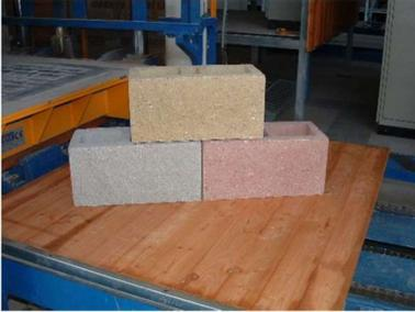
I divisori delle cantine e dei box verranno realizzati in cls senza intonaco o blocchi cavi di cls (bolognini) dello spessore di cm. 8-12-20 faccia a vista a scelta della D.L. o similari.
