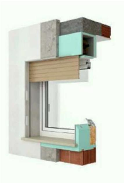
Il sistema monoblocco termoisolante Made in Italy è composto da polistirene estruso ad alta densità (XPS) accoppiato con legno OSB. Trattasi di cassonetti a scomparsa sotto intonaco, tagliati a misura, per avvolgibili; consentono di realizzare un foro finestra ad alta efficienza energetica che massimizza la resa termica e acustica.
