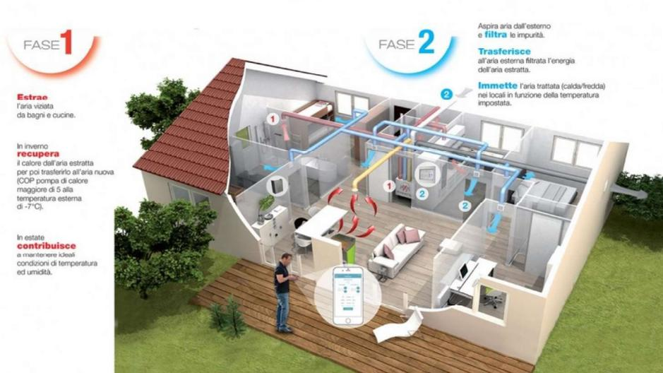
Ogni alloggio è dotato di un sistema VMC per il ricambio dell'aria con recupero del calore.
