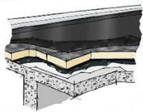
Pacchetto di coibentazione e impermeabilizzazione della copertura costituito da: Primo strato di guaina bituminosa spessore mm 3 avente funzione di barriera al vapore di risalita, strato di polistirene estruso dello spessore minimo di cm 14 e comunque da quanto previsto dalla legge 10/91, massetto in sabbia cemento pendenzato verso i tubi di scarico, primo strato di guaina bituminosa spessore mm 4, secondo strato guaina bituminosa ardesiata spessore mm 4 del
