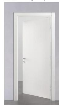
Fornitura e posa in opera di porte interne in laminatino in due colori con apertura ad anta battente e/o scorrevole a scomparsa (se previsto), costituite da ante con telaio perimetrale in legno con rinforzi in corrispondenza della serratura, e riempitivo a struttura alveolare (nido d'ape). Cerniere anuba, serratura con chiave del tipo patent standard per porte a battente, e/o serratura con placche tonde per porte scorrevoli a scomparsa (se previsto). Maniglieria in alluminio finitura argento.
