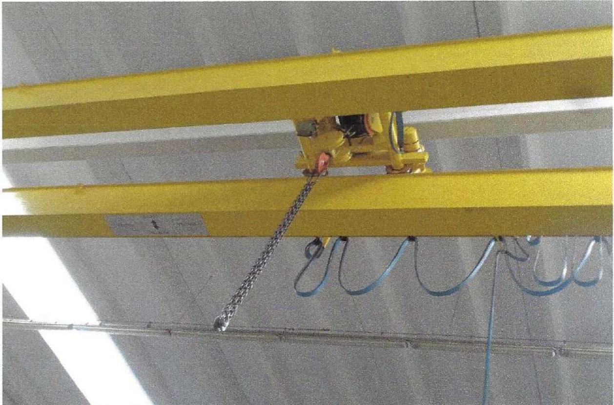
Foto particolare Carroponte : ponte principale e argano
