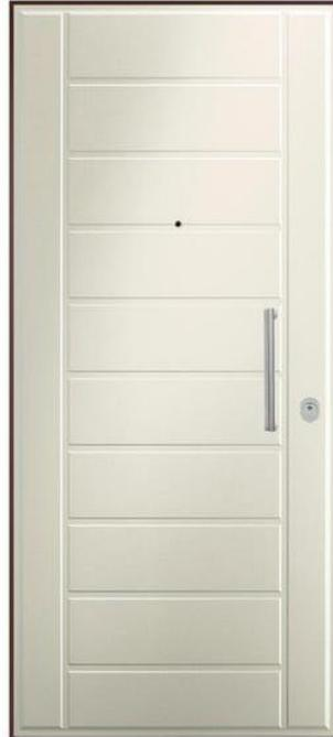
L'ingresso principale di tutti gli alloggi avrà un portoncino blindato delle dimensioni di 90x210cm in MDF con pannello esterno pantografato finitura laccata tinta a scelta della D.L., pannello interno colore conforme agli infissi interni, completo di serratura con chiavistelli comandati da cilindro europeo di sicurezza e dispositivo automatico di chiusura a pavimento, ferramenta, maniglia interna e pomolo esterno cromo satinato.
