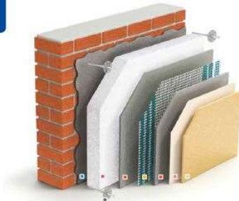
Il cappotto è un vero e proprio sistema che si caratterizza dalla presenza di una molteplicità di materiali di diversa origine e natura che lo compongono: rasanti e collanti, pannelli isolanti, tessuti di fissaggio, rete di armatura, profili ed accessori di protezione, fondi e fissativi, finitura esterna.
