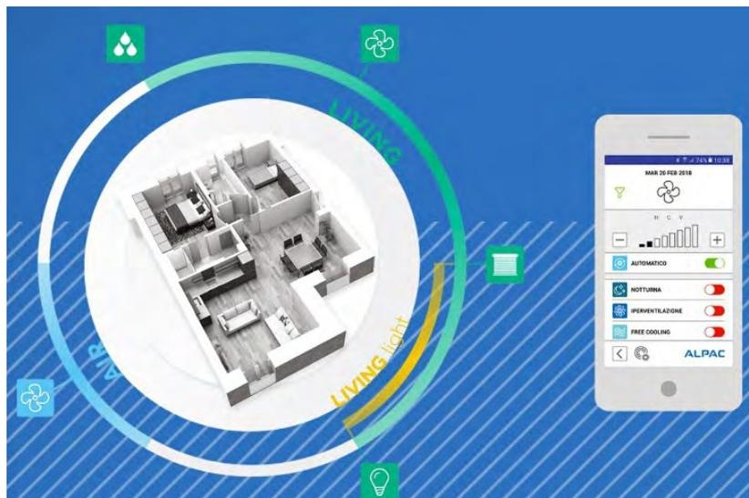
Questo innovativo sistema, per mezzo di opportuni sensori ambientali (VOC, CO2, igrometrico), permette la regolazione automatica della ventilazione adattandosi, ambiente per ambiente, al carico di lavoro necessario per mantenere l'aria sempre fresca e pulita. E' inoltre possibile grazie all'App ALPAC la gestione domotica della VMC in locale.
