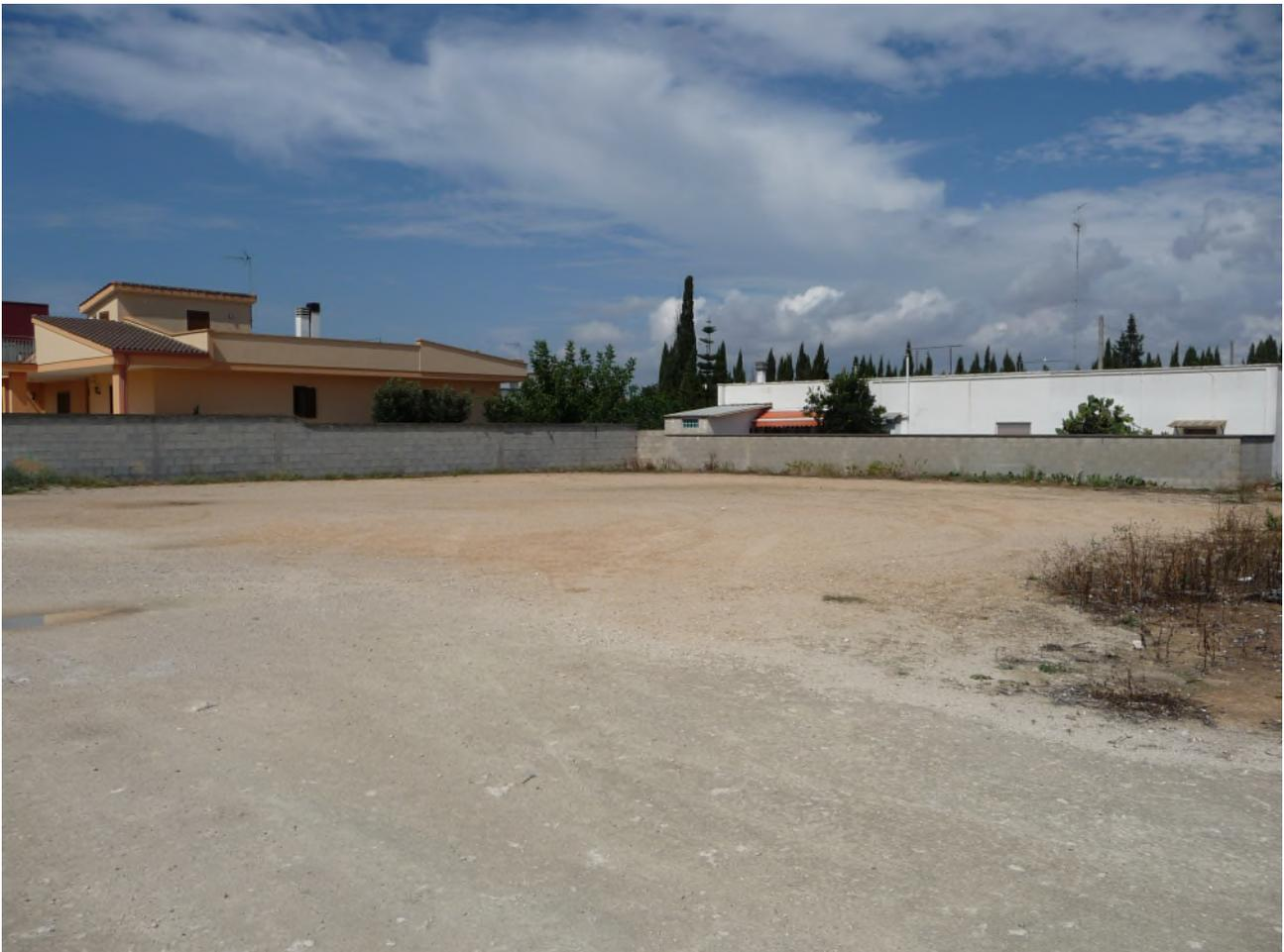
Foto 1: l'area edificabile ripresa da sud-est. Si nota la recinzione sui lati ovest e nord con mattoni di c.v. e sovrastanti livellini, alta da 1,80 a 2,20 mt. circa.
