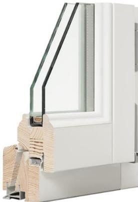
Le finestre e le porta-finestre degli alloggi saranno realizzate in legno verniciato bianco, prima scelta, impregnati, senza scuretti, con vetro camera basso emissivo, fissato con regolo ferma vetro e sigillatura con silicone, ad una, due o più ante, a finestra o porta finestra, secondo quanto risulta dai disegni esecutivo o abaco degli infissi, o secondo le prescrizioni della DL;
