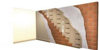
**4.3 Tramezzature interne** alle abitazioni ed ai locali accessori ai piani fuori terra sono realizzate in laterizio dello spessore minimo di cm 10 impostate su materassino fonoisolante al fine di eliminare ponti acustici.
