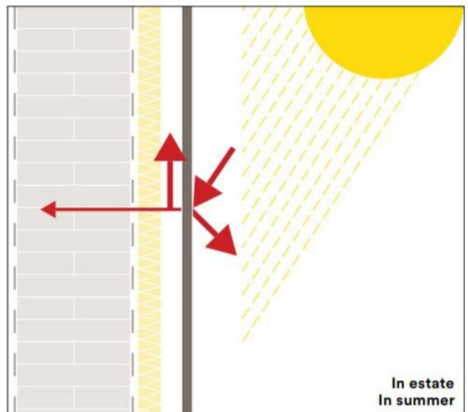
perimetrali. In entrambe le stagioni la parete ventilata diventa uno strato di protezione ad alta inerzia termica: infatti in estate produce uno sfasamento dell'onda di calore (cioè il calore penetra nell'edificio per conduzione in misura ridotta e solo nelle ore notturne, in cui la temperatura è meno elevata), in inverno prolunga il tempo di raffreddamento della parete perimetrale.
