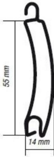
Nel tempo la stabilità del colore è pressoché assoluta. Il poliuretano espanso permette un ottimo isolamento termico e acustico. Il profilo ALL 14X55 sarà posato su guide in alluminio con idoneo spazzolino.
