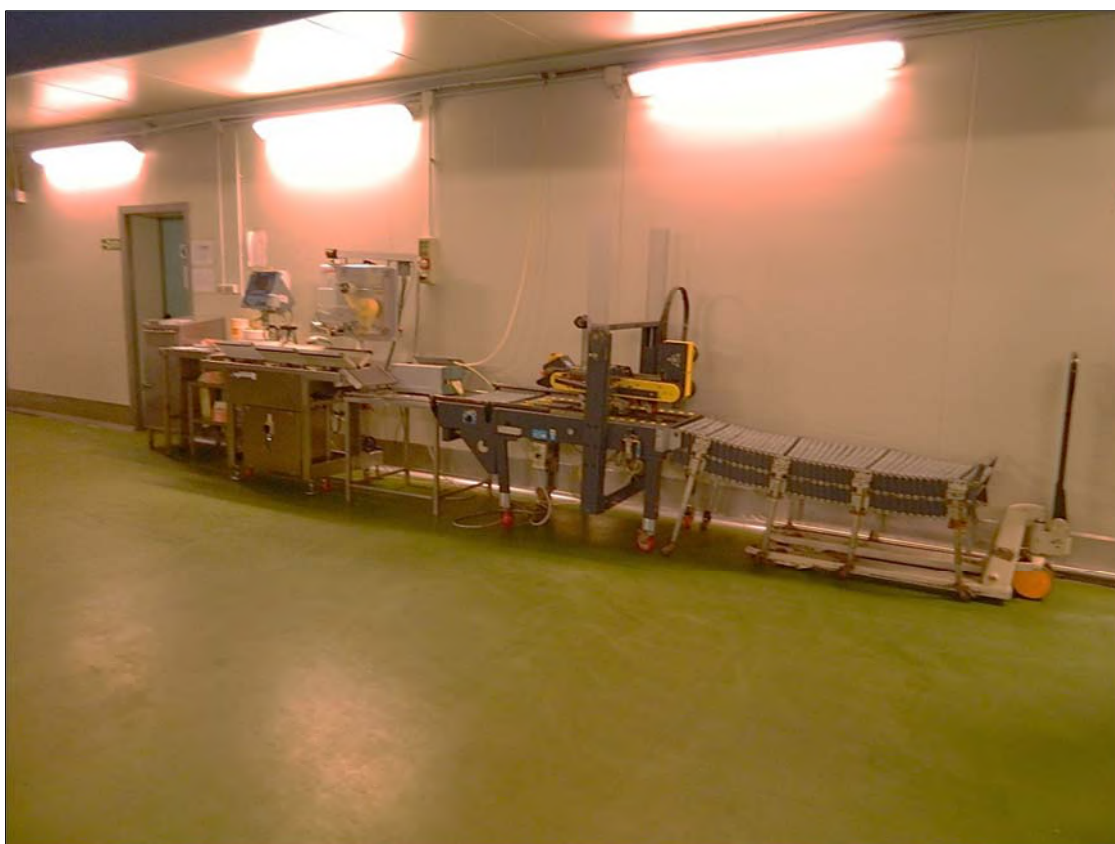
FOTO N. 24: PIANO PRIMO -particolare chiudi cartoni manuale SIAT "pallettizzazione"
