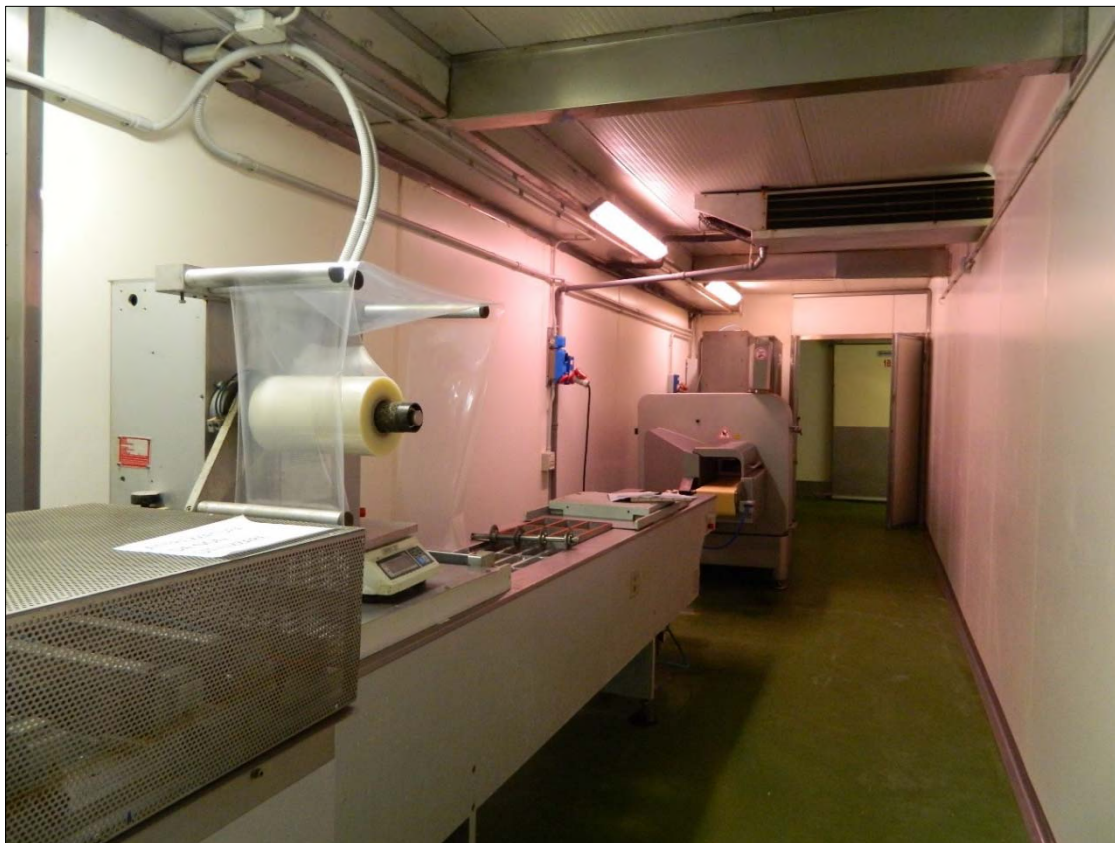
FOTO N. 29: PIANO PRIMO -thermo formatrice Veripack + pressa + porzionatrice in loc. "confez."
