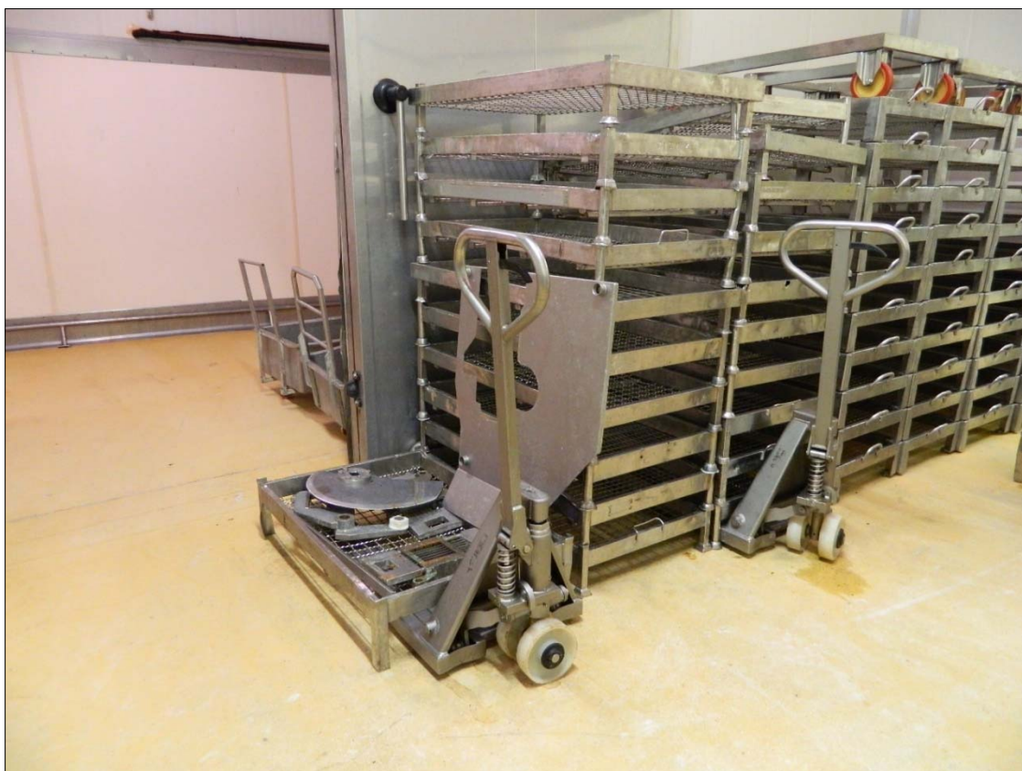
FOTO N. 6: PIANO TERRA -particolare muletto manuale inox "Samag" macchinari "zona lavaggio"
