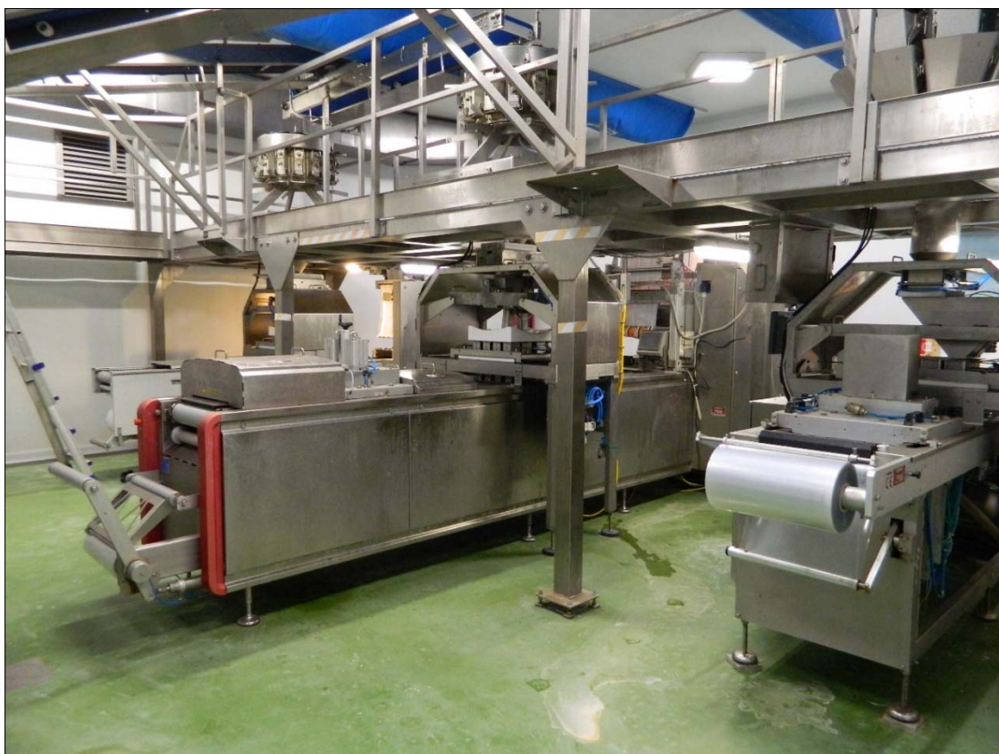
FOTO N. 12: PIANO TERRA -particolare multitesta G&P Partners 10-14 "camera bianca"
