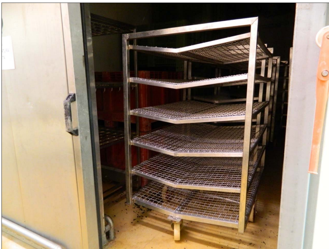
FOTO N. 17: PIANO TERRA -particolare carretti rete acciaio "asciugatura cella 2"
