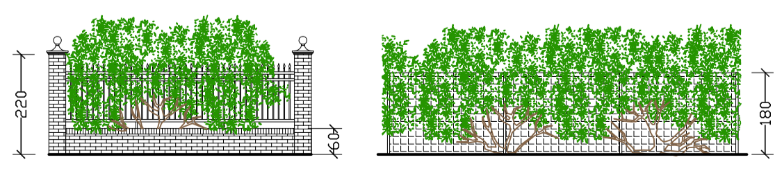
Particolare muretto ingresso e recinzione di confine scala 1:100
